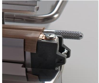
Das kleine, universal einsetzbare Folienschweißgeräte ist einfach zu bedienen und kann bei Bedarf, schnell durch das mitgelieferte Heizband, von 2,4 mm auf 5,0 mm Schweißbreite umgerüstet werden. Die Anpress-Mechanik erlaubt das Verschweißen von Folienbeuteln bei gleichzeitigem Fixieren des Beutels mit den Händen.
