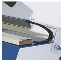
Eine Blattfeder sorgt dafür, dass der Hebel nach dem Schweißen geöffnet bleibt. So sind beide Hände frei zum Einführen des Beutels.
