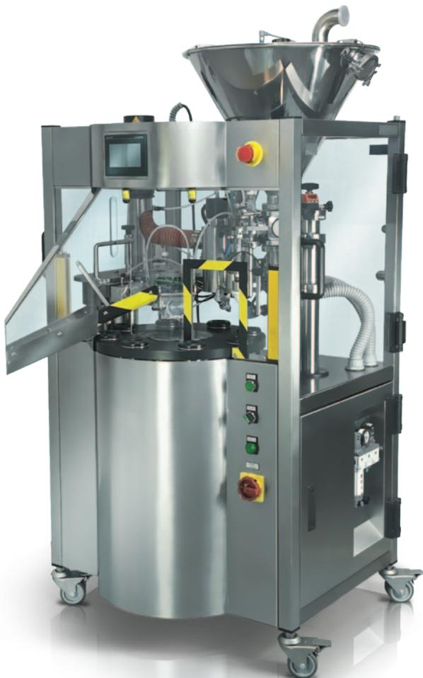
Kompakte, sehr effiziente kleine universell einsetzbare Tischmaschine zum Befüllen von Kunststoff aller Art, sowie Laminattuben mit Cremes, Gelen oder ähnlich dichten Flüssigkeiten. Heißluft- Versiegelung, inkl. Kodierung und Trimmen der Siegelnaht.
